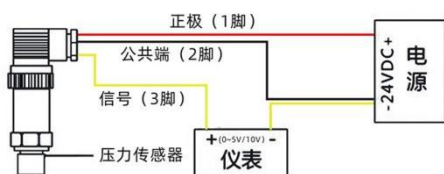
三线路电压输出接线图
