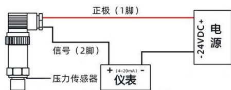
两线路电流输出接线图
